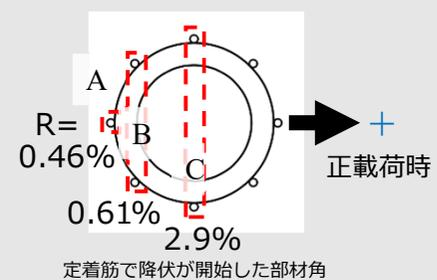
引張縁の定着筋Aから降伏し最大荷重付近
